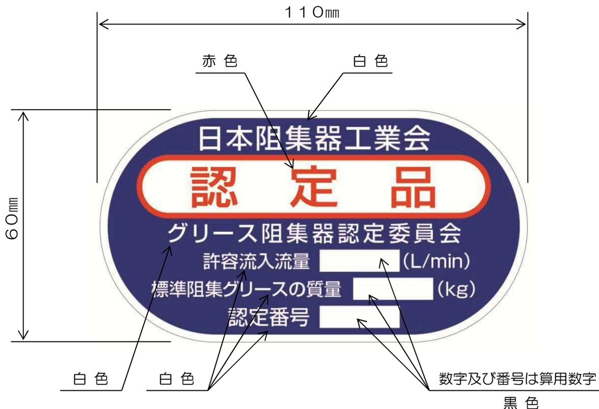
注) シール材質は、厚さ50  $\mu$ mの印刷用粘着フィルムとする。
